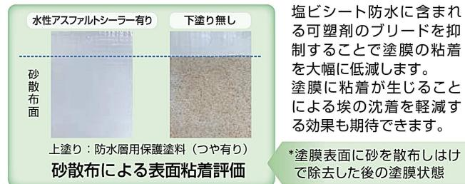
塩ビシート防水に含まれる可塑剤のブリードを抑制することで塗膜の粘着を大幅に低減します。
