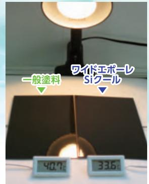
鋼板面に塗装し、レフランプの光を当て、裏面温度を測定
