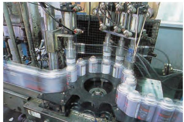
ガス充填作業 Propellant Filling
