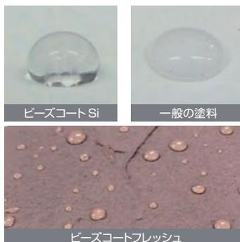
ハスの葉の上では、雨水や露はビーズのような球状の水滴となって落ちて行きます。このハスの葉構造の原理を応用し、表面に微細な凹凸を施したビーズコートは、泥汚れや雨筋、水濡れによるかびや藻の発生を抑制し、塗膜の美観を長期にわたり保ちます。
