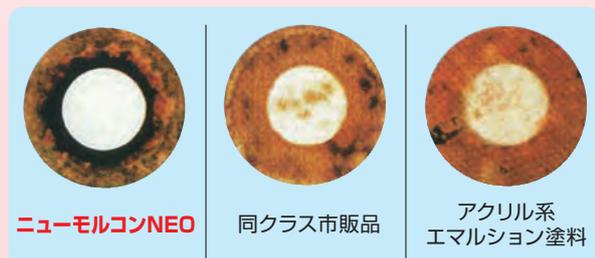
試験はJIS Z 2911 (かび抵抗性試験方法)による。
