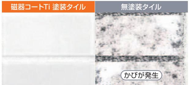
酸化チタンに光が当たると、その表面に水が吸着することにより超親水性機能が発現されます。超親水性の表面では、水が表面と汚れの間に入り込み、汚れを浮き上がらせます。
